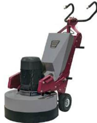
Первый проход шлифования самый важный. Полированную машину необходимо вести равномерно, без резких движений и нажимов, по траектории «крест на крест». Главная задача шлифования равномерное открытие заполнителя.
